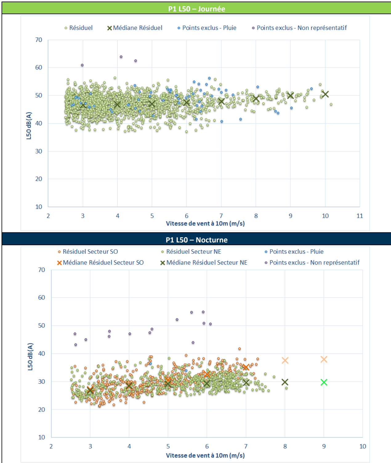
Figure 5 : Bruit en fonction de la vitesse de vent standardisée au point P1
