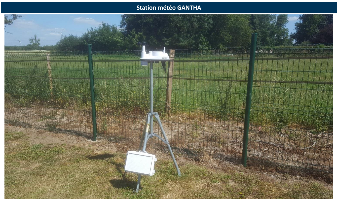
Figure 2 : Station météorologique à 1,5 m
